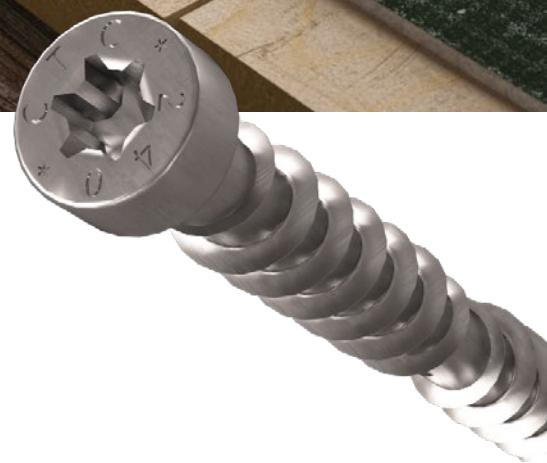
CTC ist der Verbinder für Holz-Beton-Decken. CE-zertifiziert, erlaubt es die Verbindung einer 5 oder 6 cm dicken Betonplatte mit den Holzbalken der darunter liegenden Decke, wodurch eine neue Holz-Beton-Konstruktion mit außerordentlicher Festigkeit und ausgezeichneten statischen und akustischen Eigenschaften entsteht. Das System ist zugelassen, selbstbohrend, reversibel, sehr schnell zu montieren und nicht invasiv.
